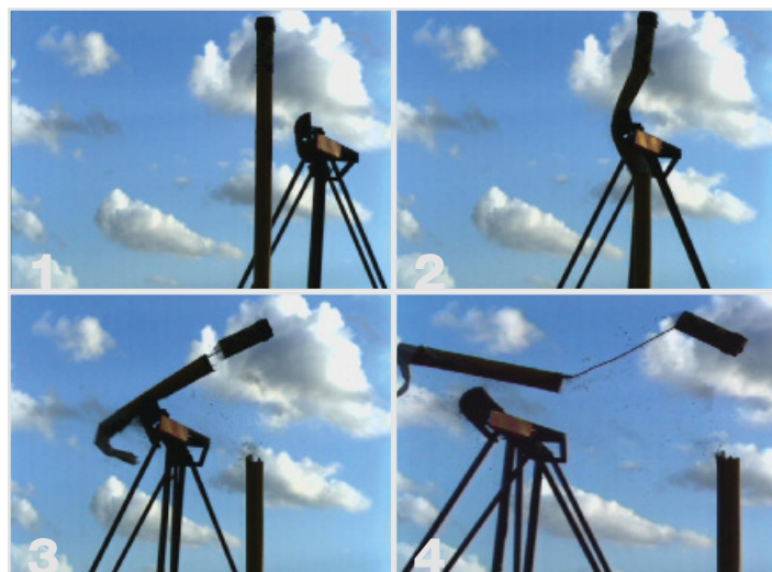
La secuencia de imágenes muestra el mástil de Pollite que ha recibido un impacto a 140 km/h
